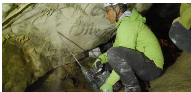
Realizzazione di fori nell'ammasso roccioso per la misura della temperatura della roccia.
